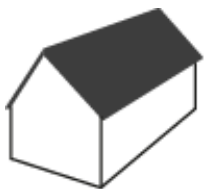
Comble en bâtière (à deux versants)
